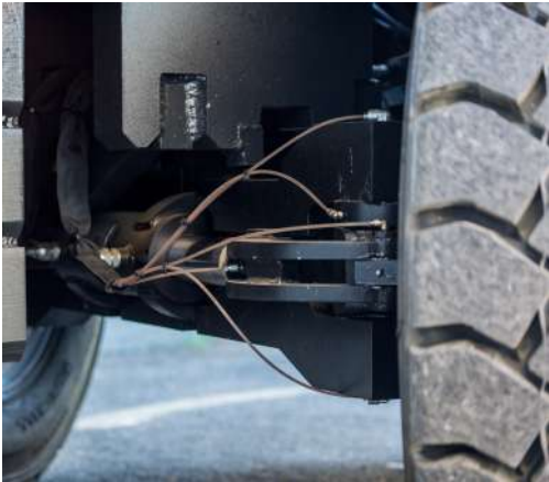
Ingrassaggio ponte - Axle greasing
