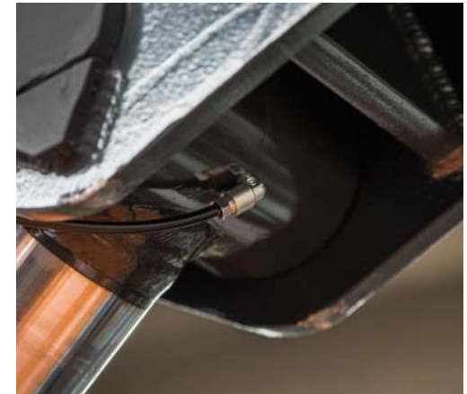
Ingrassaggio braccio - Boom greasing
