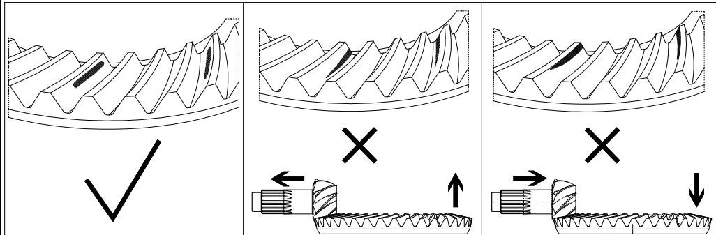
Per rendere visibile il contatto tra i denti, applicare un sottile strato di vernice brillante su alcuni denti della corona dentata. Ruotare il pignone in entrambe le direzioni fino a quando la superficie di contatto dei denti diventa visibile. Se la regolazione della coppia conica è corretta, il contatto tra le superfici dei denti sarà ottimale.
